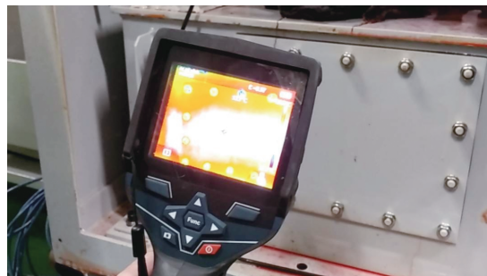
過熱設備の表面温度を測定
