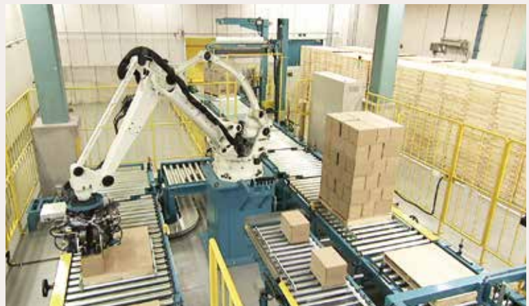
パレタイジングロボット LPA180 ダンボール箱から袋物、ビン、金属製品まで 高速・高精度にパレタイズ
