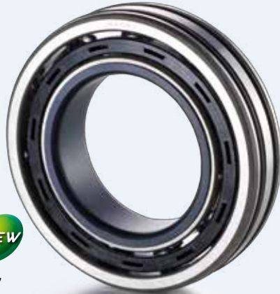
樹脂インサート軸受 外輪、内輪に絶縁性に優れた樹脂を一体成型し 軸受内部への電流通過による電食を防止
