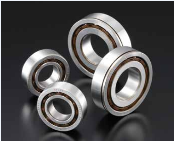
複列4点接触玉軸受 複列ゴシックアーチ形状により剛性を確保
