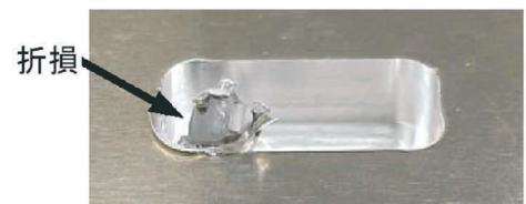
(a)超硬無処理エンドミルで加工したワーク
