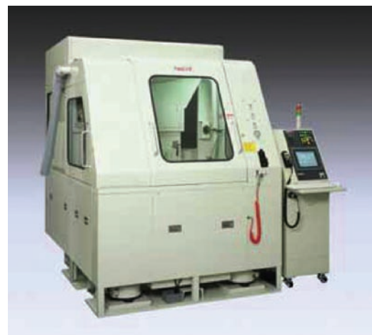
図4. リニアモーターと静圧ねじを用いたナノグルーブ AMG92P (NACHI)
