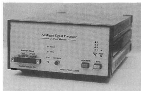
図5. 3点法真円度測定ユニット (210 W ×110 H ×300 D )
