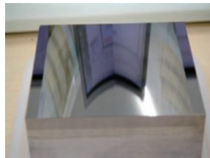
図7 A軸角度可変加工をしたサンプルワーク
