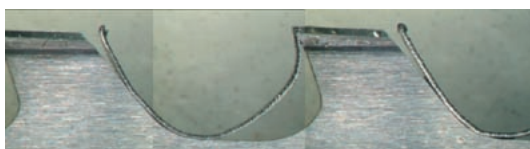
図10 刃溝ポケットに張付いた切りくず
