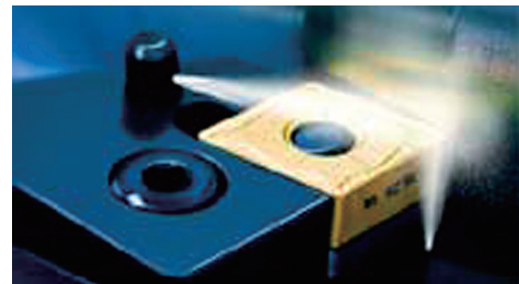
図4 MQL旋削工具(フジBC技研提供)
