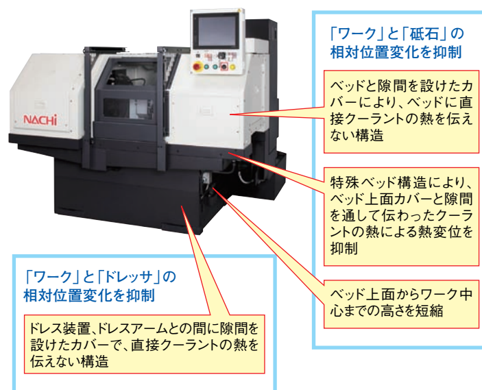
図8 熱変位の抑制
