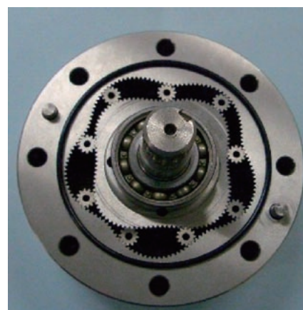
図5 試作供試モーターの内部構造写真
