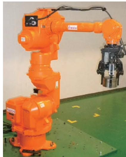
図6 MR50とフレックスハンドを使った重量物の搬送事例
