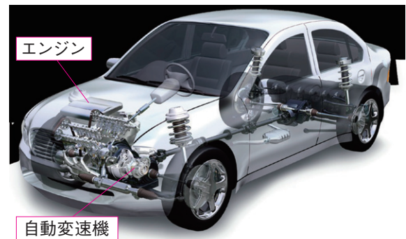
図1 自動変速機の搭載位置
