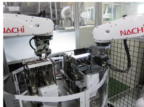
図4 ロボットを使った自動検査ライン
