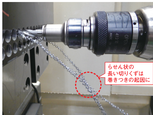
図2 横形マシニングでの切りくず写真
