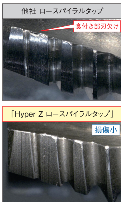
図5 高硬度鋼 140穴加工 工具摩耗比較
