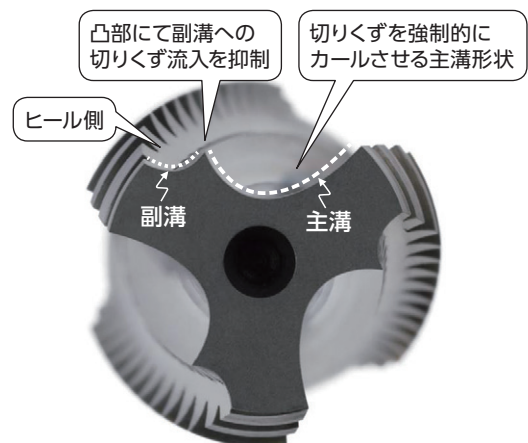
図3 「Hyper Z スパイラルタップ チタン合金用」特殊ダブルフルート形状(PAT)
