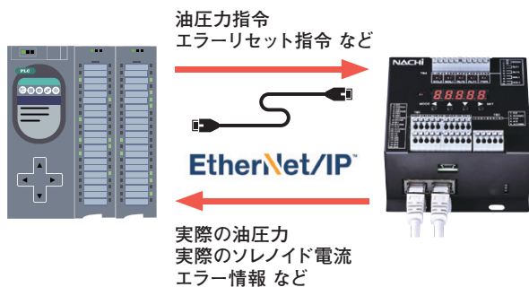
図9 EtherNet/IP™通信でのデータ伝送
