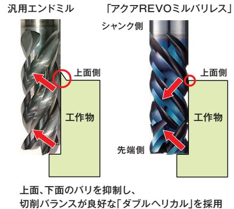
上面、下面のバリを抑制し、切削バランスが良好な「ダブルヘリカル」を採用
